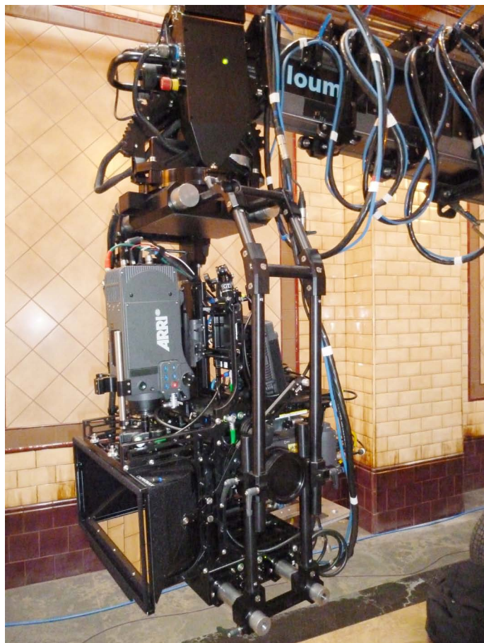
Louma 2 avec Pace 3D rig underslung sur « Hugo Cabret », avec deux Alexas, objectifs Cookes, moniteurs Transvideo.
